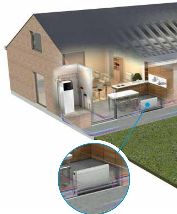
Vorlauftemperaturen bis 65 °C, sodass das Gerät sowohl mit Fußbodenheizung als auch mit Heizkörpern arbeiten kann.
